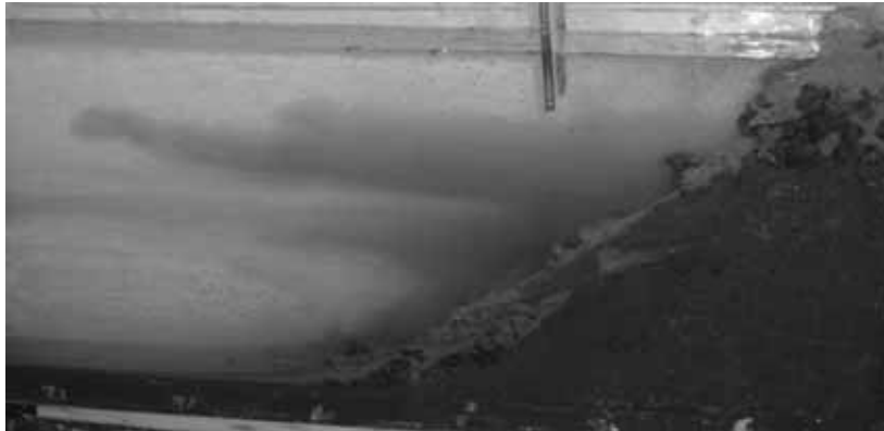
Рис. 3. Борт кар'єру після обвалу (модель). Соленосна порода вкрита шаром нерозчинного осаду і продуктами руйнування берега.
