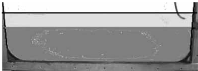
Рис. 7. Розповсюдження прісної води по поверхні розсолу на моделі
